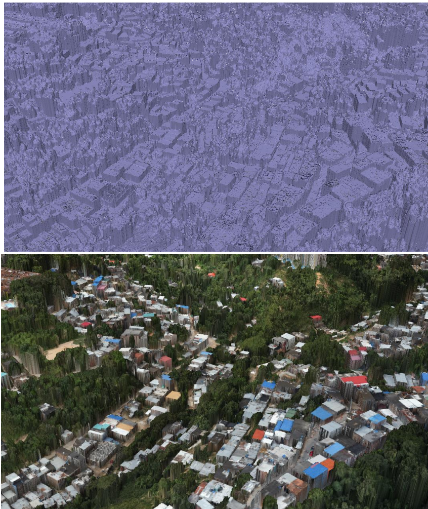
Figura 10. Modelo de malla con triangulación, visualización en alambre y texturizado.
