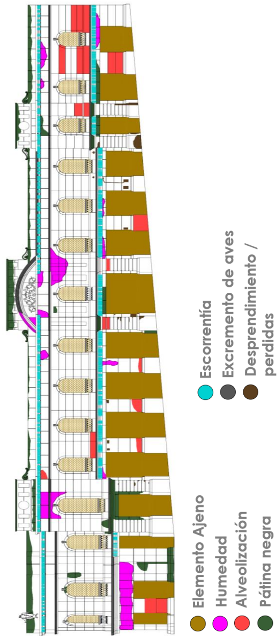
Figura 93. Análisis de los elementos patológicos que afectan la fachada del pabellón de carnes, fachada sobre la calle 34.
