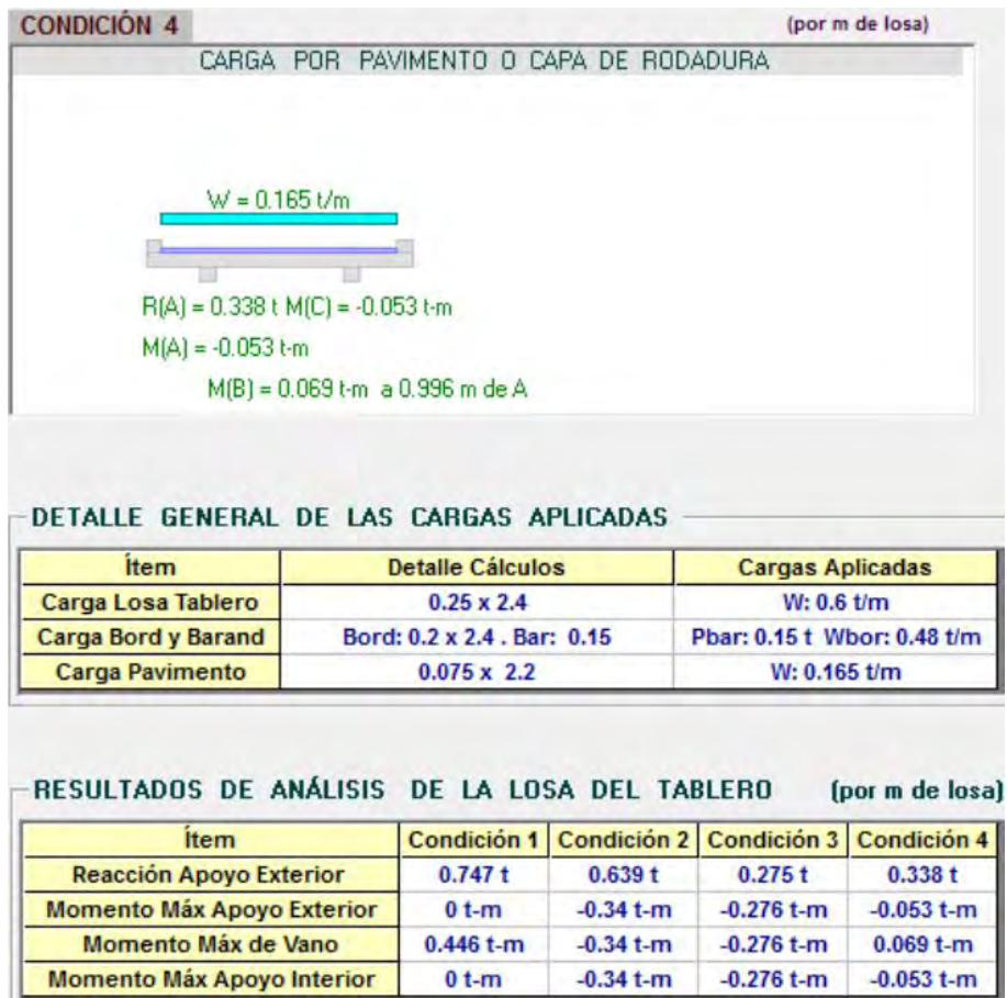
Figura 46. Análisis y cálculo de las solicitaciones de diseño a momentos flectores en la placa del tablero para las cargas DC, DW y LL+IM. Continúa en figura 47.
