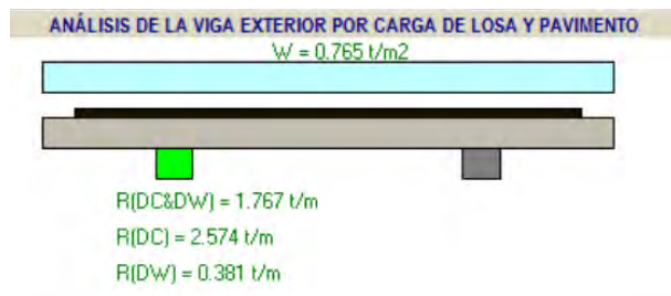
Figura 41. Análisis y cálculo de las solicitaciones de diseño a momentos flectores y fuerzas cortantes en las vigas longitudinales para las cargas DC, DW y LL+IM. Continúa en figura 42.
