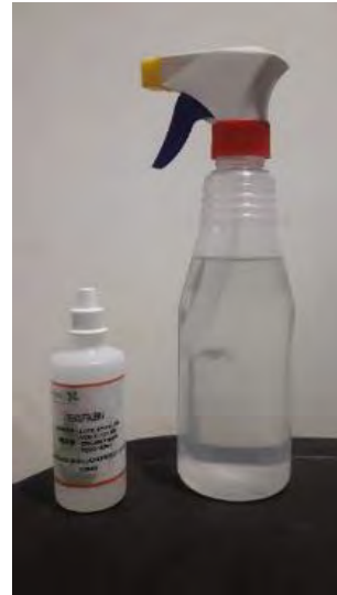
Figura 25. Materiales utilizados para le determinación del ensayo de carbonatación en el paciente
