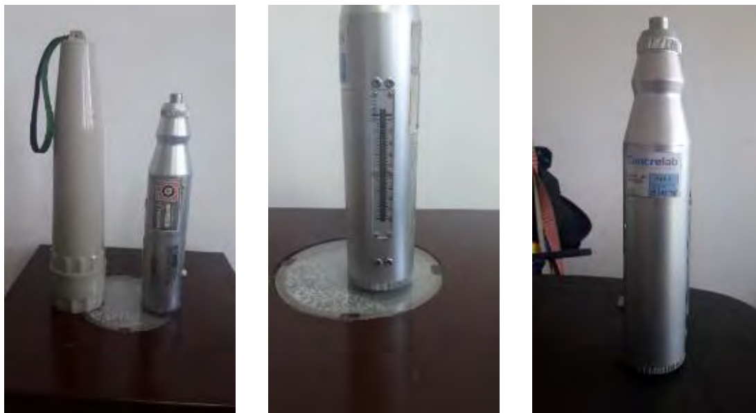
Figura 22. Esclerómetro Marca CONTROLS. Se aprecia la regla para la toma de lecturas y etiqueta con la fecha de la vigencia de la calibración.
