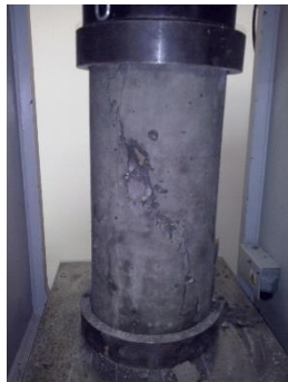
Foto 13. Falla de un cilindro de concreto en la máquina de compresión - laboratorio USTA
