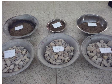
Foto 104. Ensayo de humedad – Muestras húmedas
