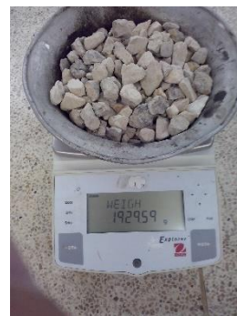
Foto 106. Ensayo de humedad – Muestra de grava seca
