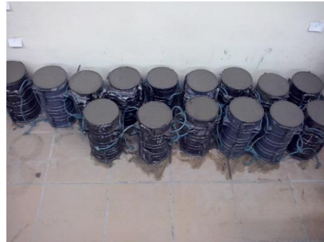
Foto 12. Acopio de los cilindros de concreto fresco - laboratorio USTA
