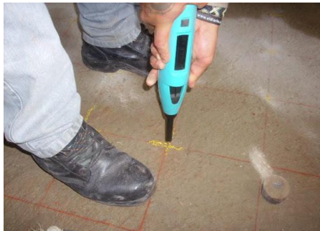
Figura 28. Prueba de Esclerómetro Conjunto Smart Clarisas
