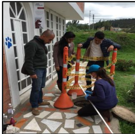
Fotografía.4. Toma de muestra de agua residual.
