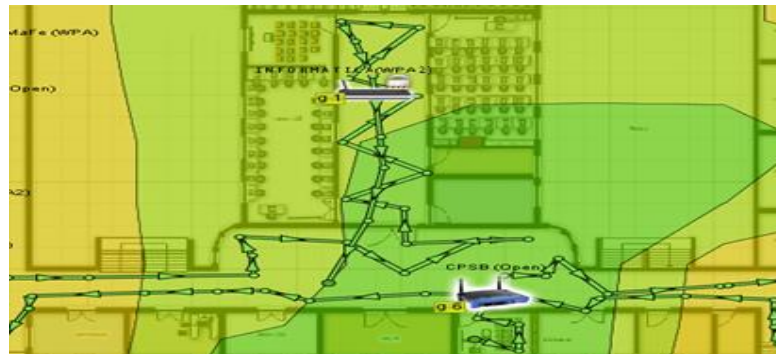
Figura 57. Escáner BSA del AP pasillo piso 2, resultado
