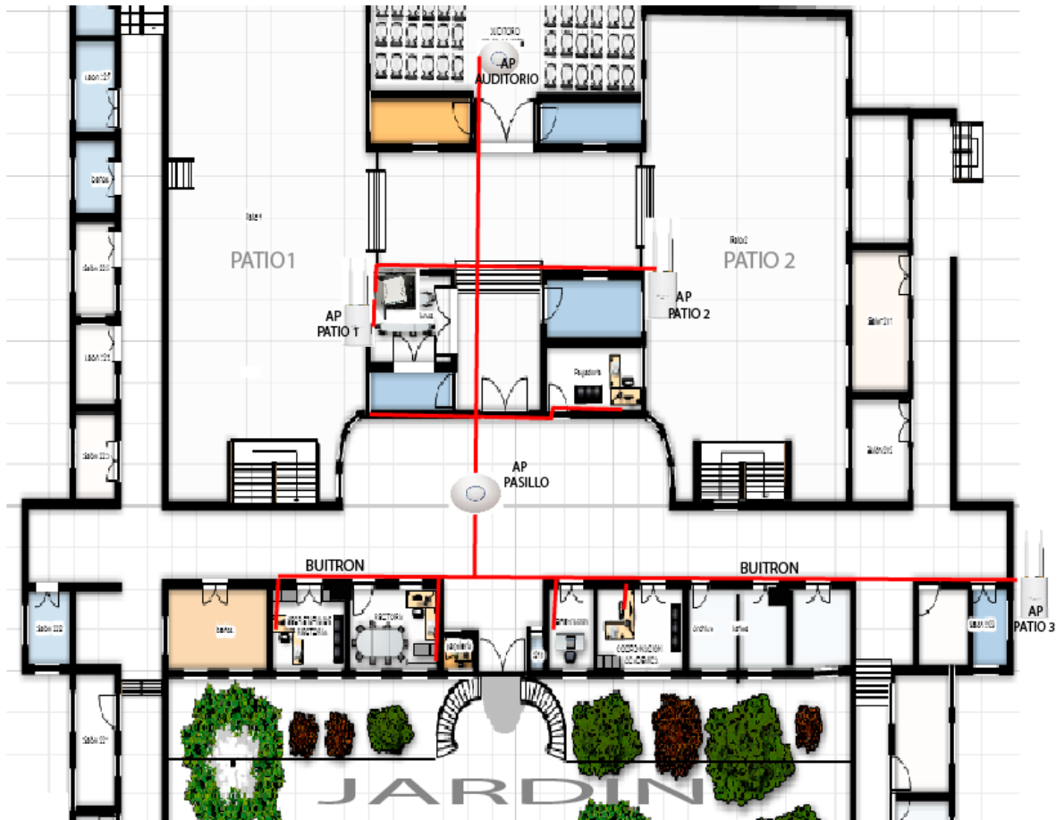
Figura 41. Ubicación de AP y DS de WLAN Primer piso CPSB, diseño
