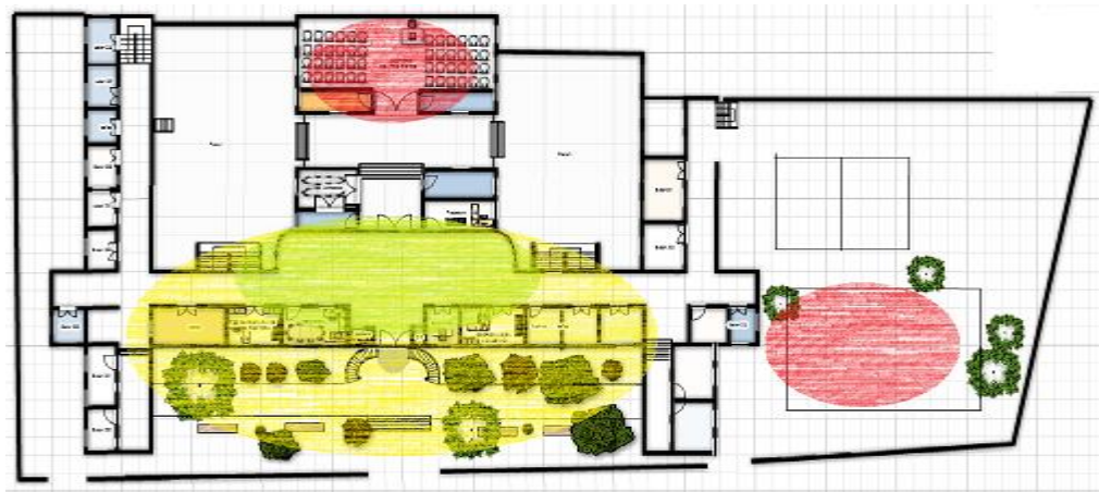
Figura 29. Densidad de usuarios WLAN piso 1, CPSB
