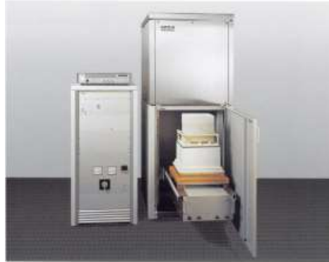
Ilustración 9 aparato para medir la conductividad térmica TCT 426
