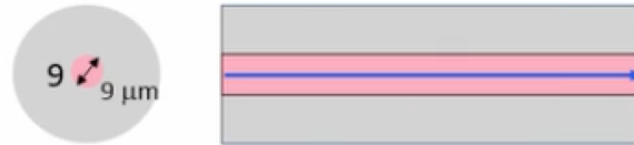
Figura 3.3.2: Fibra monomodo Fuente: (Chaparro Becerra, 2025)
