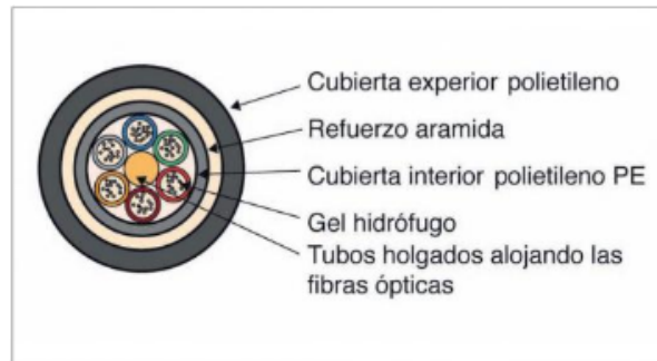
Figura 3.3.5: Componentes cable ADSS Fuente: (Trashorras, 2013)
