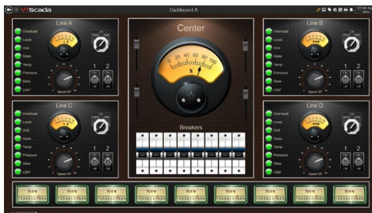
Figura 9. Interfaz de control y monitoreo VT SCADA
