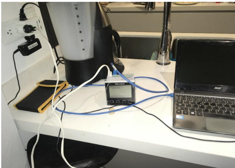
Figura 29. Analizador de red conectado al PC y red eléctrica vivienda
