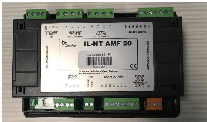
Figura 36 Parte trasera controlador planta emergencia
