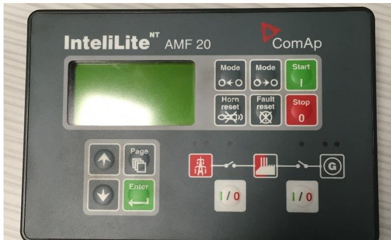
Figura 35 Controlador planta de emergencia
