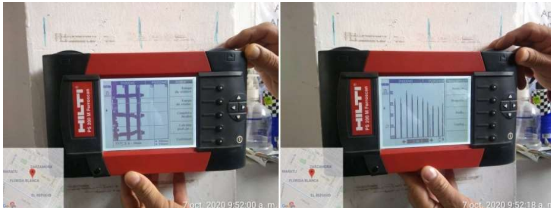
Ilustración 6 - Escáner a columna piso 1
