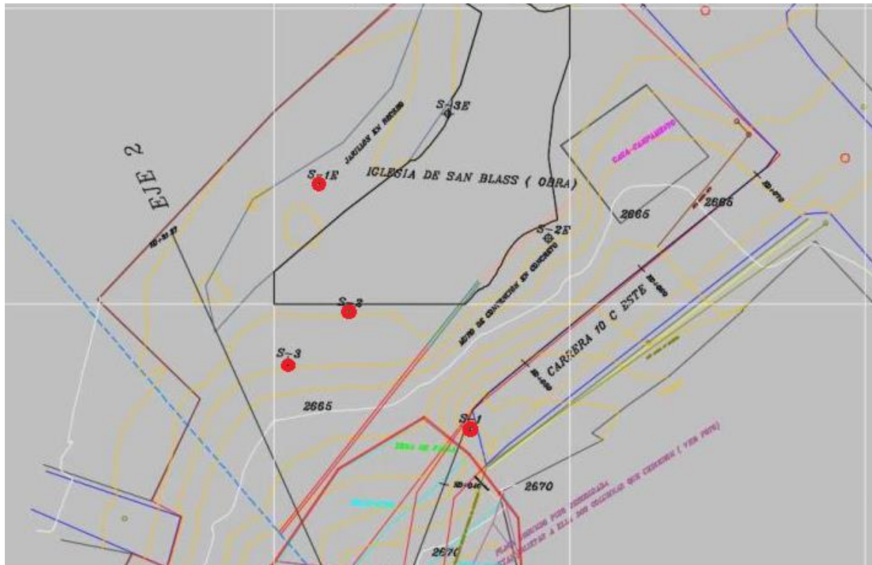
Levantamiento topográfico 2: Localización de los sondeos S-1, S-2, S-3, y S1E. Fuente: Constructor Parroquia de San Blas
