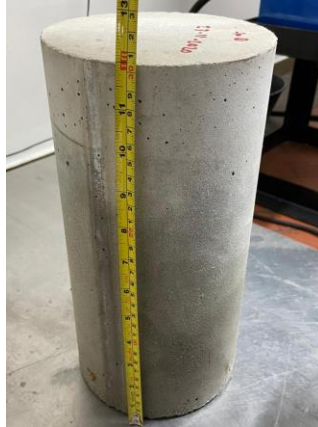
Fig. 4. PREPARACIÓN DE LOS CILINDROS PARA FALLARLOS.
