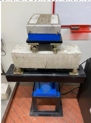
Fig. 11. VIGA DE CONCRETO CON DOSIFICACIÓN DE 25 KG/M3, 25-6V.
