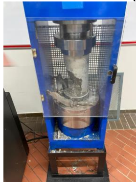
Fig. 5. FALLA DEL CILINDRO 25-6 (28 DÍAS).
