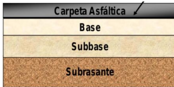
Figura 27. Estructura de pavimento flexible.
