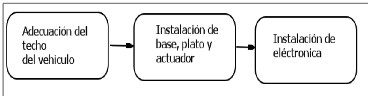
Figura 10 Secuencia de instalación de la antena
