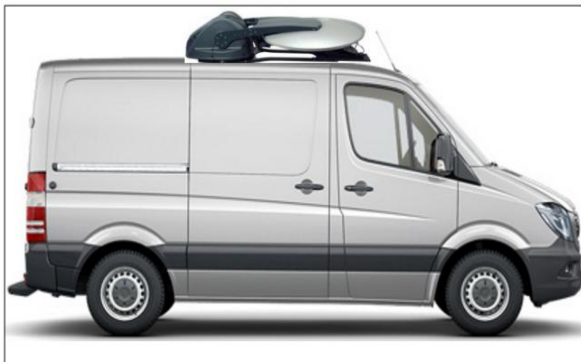
Figura 8. Visión 3D antena plegada. (Fuente Autor. Imágenes tomadas Antena Inetvu- Camioneta Sprinter)
