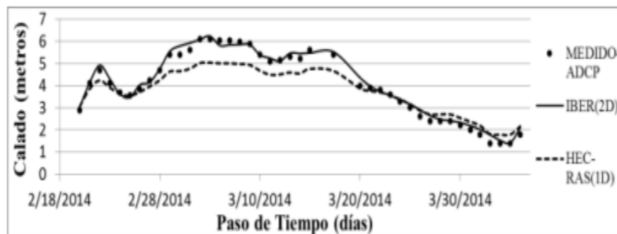
Figura 6. Resultados de calado de agua en los dos modelos vs datos de monitoreo en la sección del dique Bell Ville
