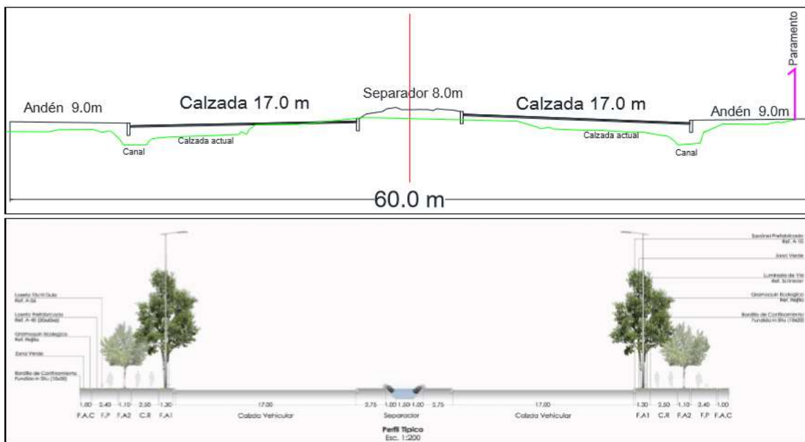
Ilustración 13. Sección transversal típica actual (línea verde) y proyectada (línea negra y figura inferior) de la zona particular de estudio.
