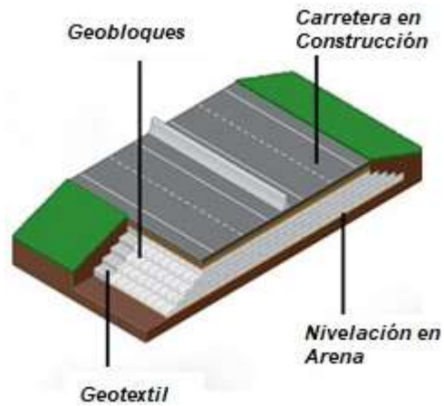
Ilustración 40. Colocación de bloques de EPS en la construcción de terraplenes.
