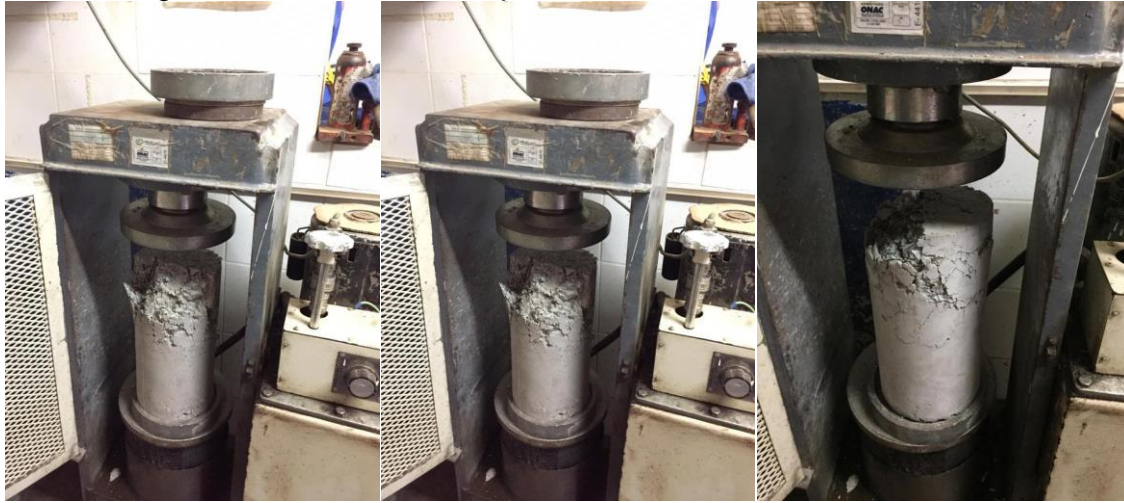
Fotografía 10.2. Falla a compresion del concreto con 25% de PET.
