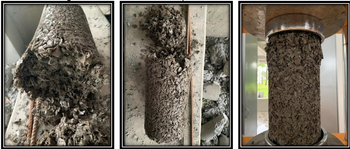
Fotografía 10.4 Esfuerzo a compresión concreto 75% de PET
