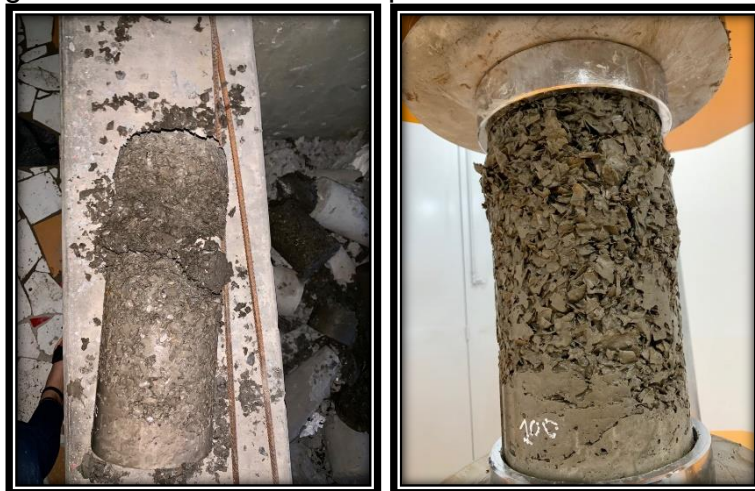
Fotografía 10.5 Esfuerzo a compresión concreto 100% de PET
