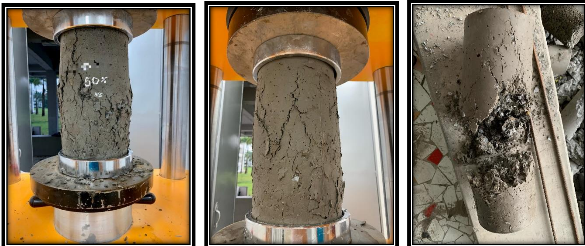
Fotografía 10.3 Falla a compresión concreto con 50% de PET
