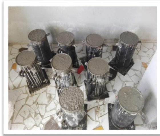
Fotografía 10.1 Moldes cilindricos con su respectiva mezcla de concreto
