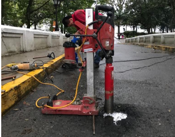
Imagen 13: Fotografías de la extracción de núcleos para prueba de resistencia del concreto
