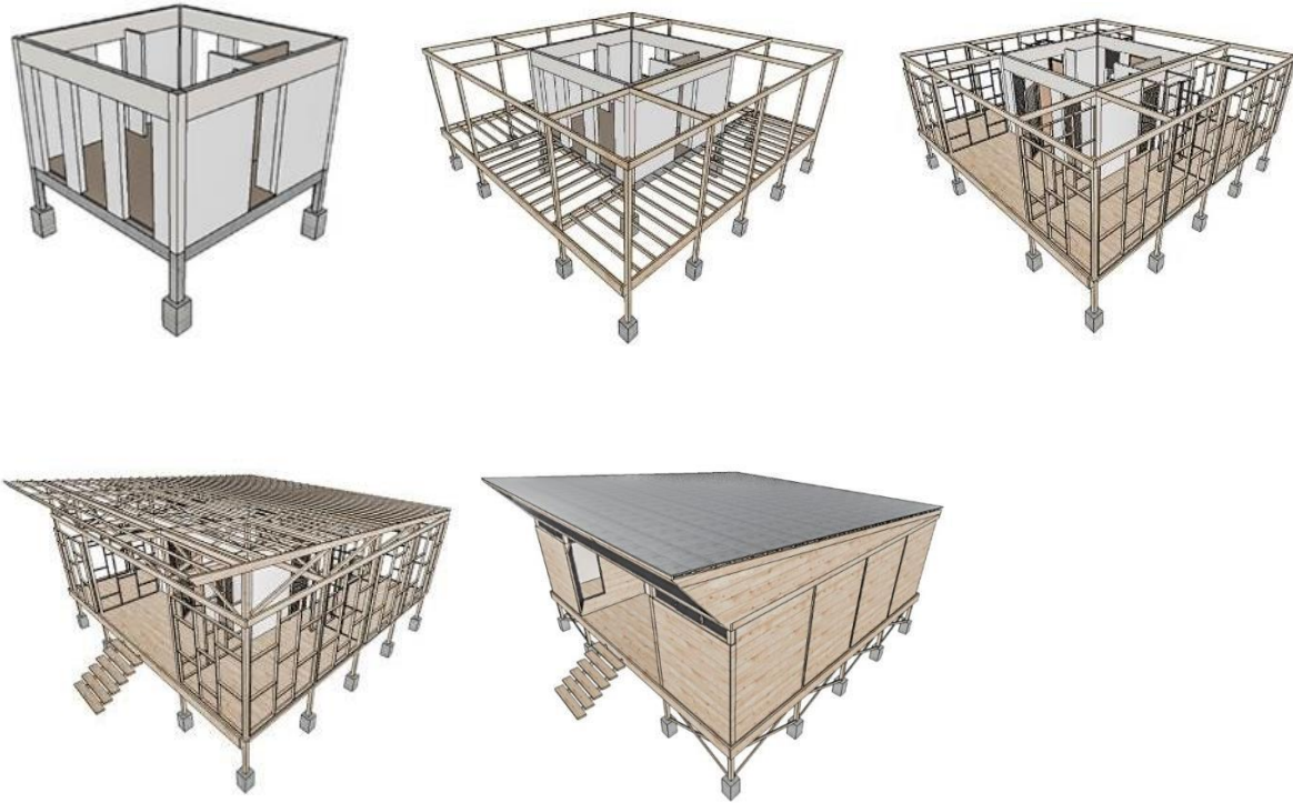
Figura 13. Esquema técnico constructivo. Fuente archidaily.
