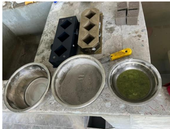
Figura 11. Mezcla mortero + Mucilago de Nopal
