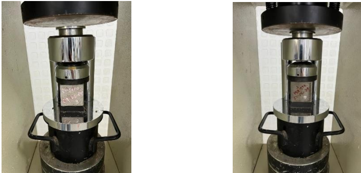
Figura 18. Ensayo a compresión en los cubos
