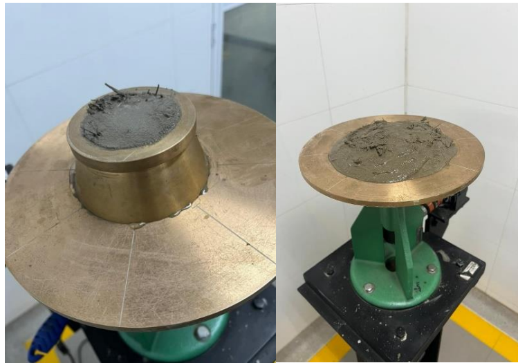
Figura 15. Mortero con agregados (bagazo de caña y mucilago de nopal) en ensayo de fluidez.
