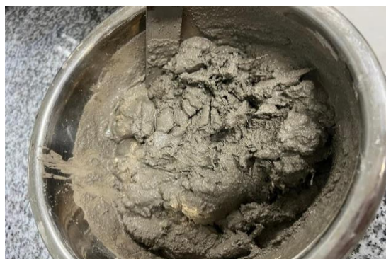
Figura 14. Mezcla de mortero con adición de bagazo de caña y mucilago de nopal
