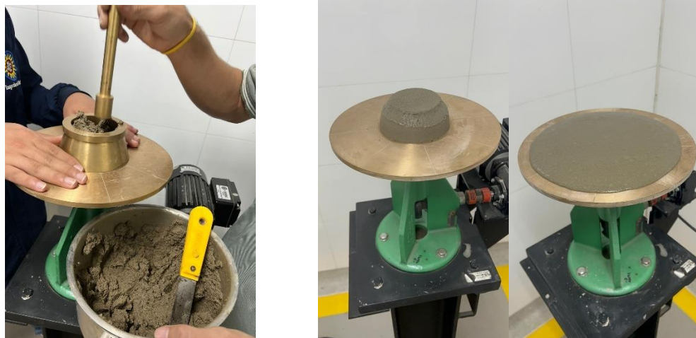
Figura 6. Mortero convencional en ensayo de fluidez
