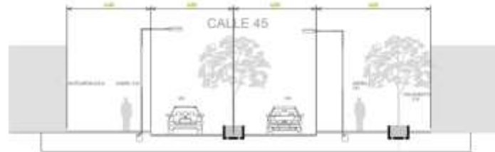
Figura 26. Perfil vial existente calle 45 vía primaria
