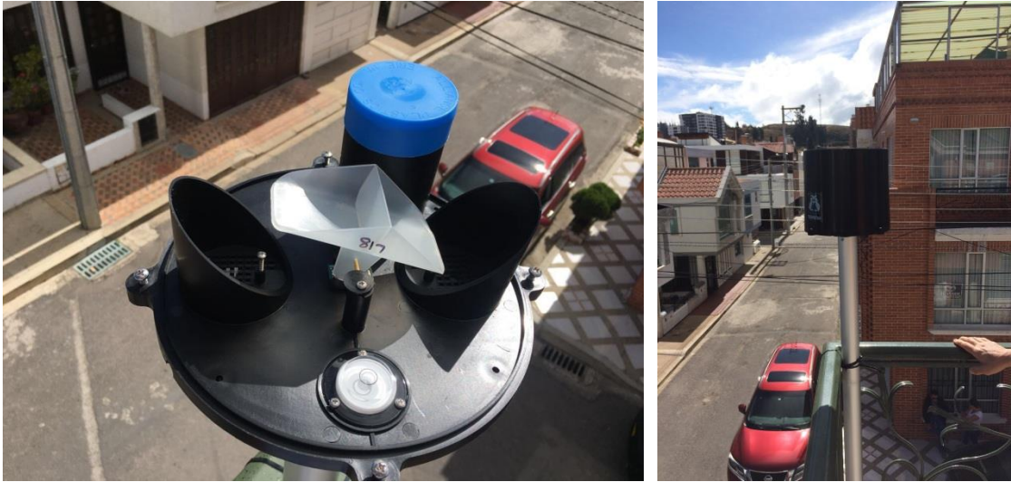
Figura 19. Pluviómetro de Balancín modelo- RainLog 2.0 con datalogger - RainLogge Marca: Rainwise. (Autor).
