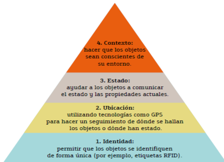
Figura 57. Modelo objeto dentro de IoT, Sensor Telemetry, Accenture, 2005
