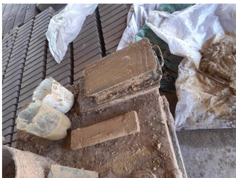
e. Elaboración y moldado del ladrillo.
