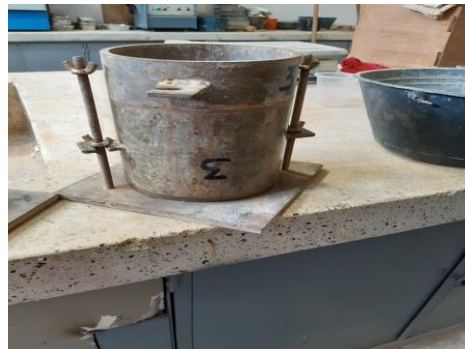
j. Molde de acero con collar de extensión.
