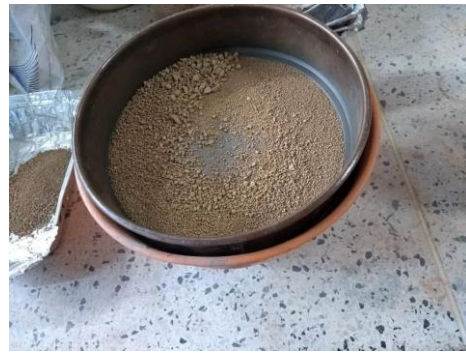
b. Filtrado de partículas a través del tamiz #40.
