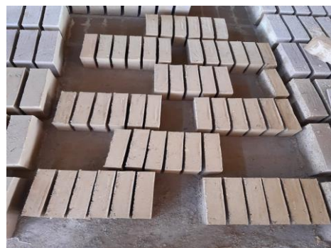
f. Ladrillos totalmente terminados y en proceso de secado.
