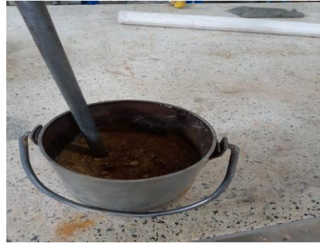
d. Material S.S.S compactado.
