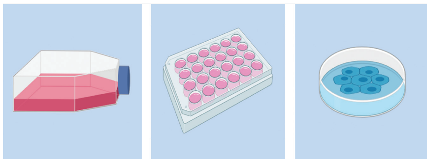
Figura 7. Representación esquemática de sistemas de cultivo en monocapa. Frascos de cultivo, placas multipocillos y cajas de Petri poseen un compartimento único en donde los nutrientes se difunden a las células y el intercambio de gases ( \text{CO}_2 y \text{O}_2 ) ocurre solo en el interfaz medio/gas.
