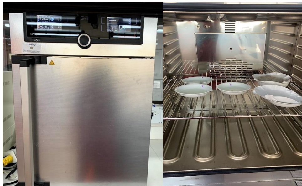
Figura 25 Horno para evaporar a sequedad el papel filtro a 105°C
