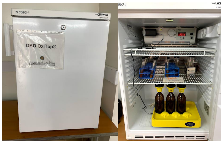
Figura 19 Incubadora TS 608/2-i para proceso DBO OxiTop
