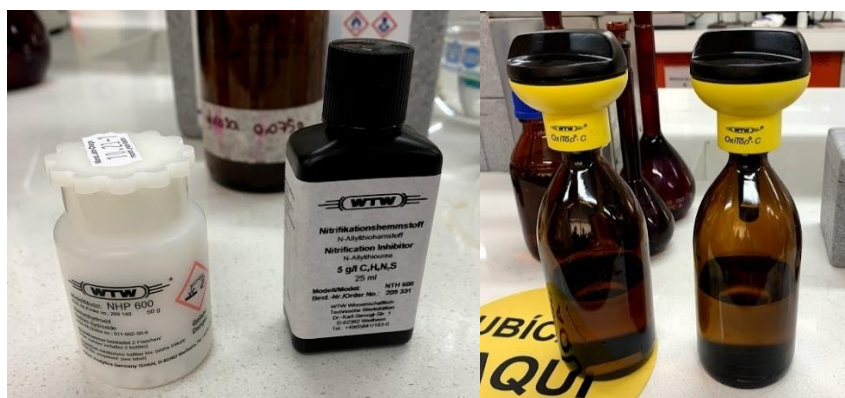
Figura 17 Perlas de NaOH , inhibidor de nitrificación y botellas OxiTop en calibración
