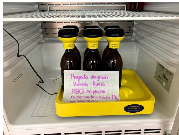
Figura 20 Montaje de las botellas con los cabezales OxiTop para medición de DBO
