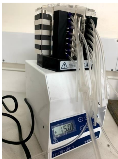
Figura 6 Bomba peristáltica de laboratorio MINIPULS® 3 Gilson para el control del caudal de entrada y salida del biorreactor
