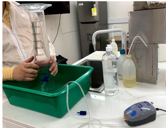
Figura 4 Prueba de probeta invertida para estimado de aire suministrado
