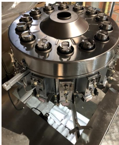
Figura 13. Distribución del multicabezal mediante vibradores controlados.
