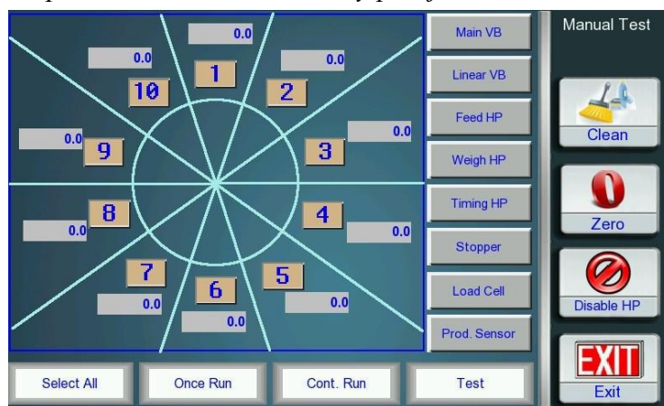
Figura 20. Proceso de prueba manual: Selección y pesaje de todas las tolvas.
