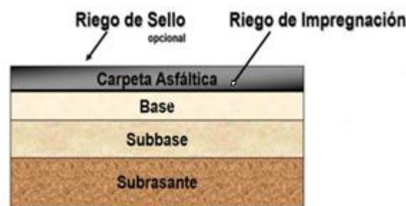
Figura 11. Estructura de Pavimento Flexible
