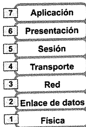
FIG.5. CAPAS MODELO OSI
