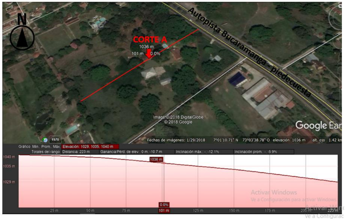
Figura 69. Perfiles de elevacion transversal A lote
