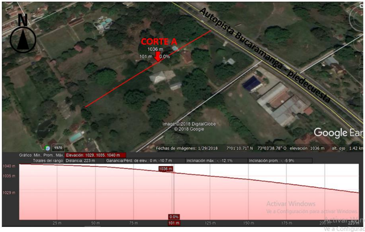
Figura 36. Perfiles de elevacion transversal A lote
