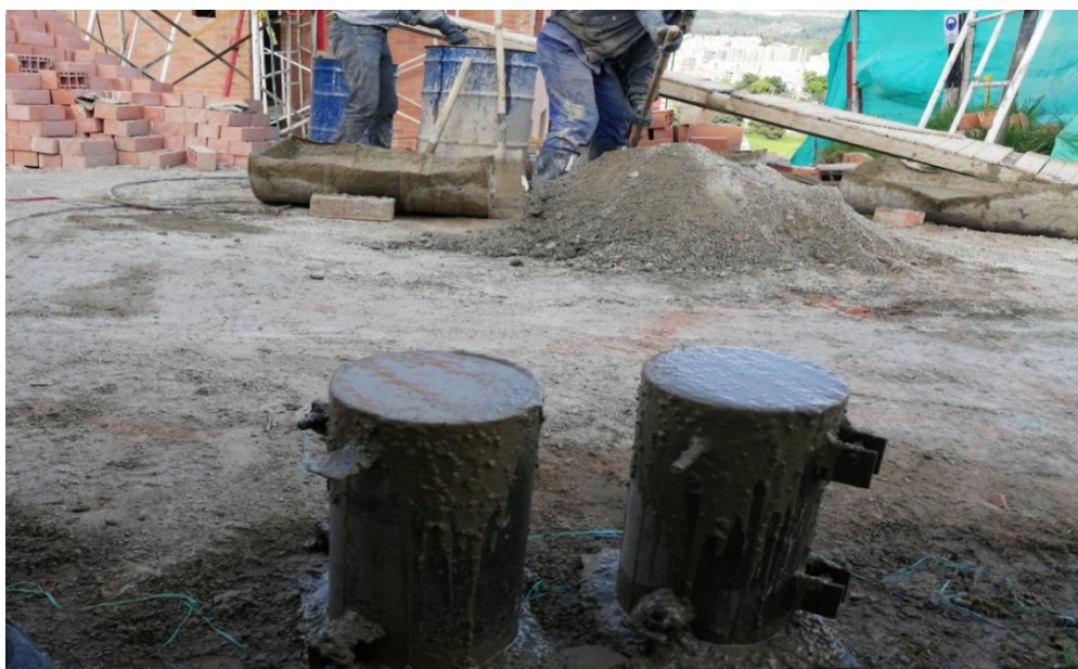
Ilustración 13 Toma de muestra cilindros de concreto.
