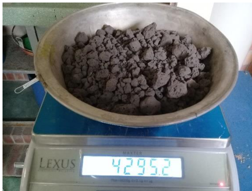
Anexo 41. Material resultante del ensayo de desgaste en máquina de los ángeles a ENHAE con 500 revoluciones retenido en el tamiz N°12
