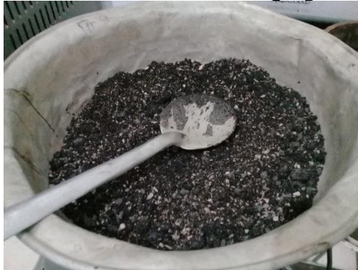
Anexo 54. Proceso de unificación de asfalto con agregados-Parte 2
