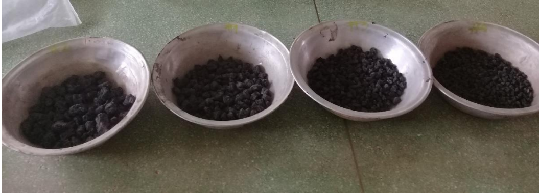
Anexo 39. Partículas de ENHAE utilizada para ensayo en máquina de los ángeles
