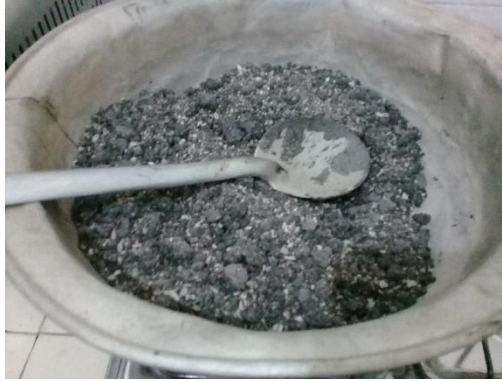
Anexo 53. Proceso de unificación de asfalto con agregados-Parte 1
