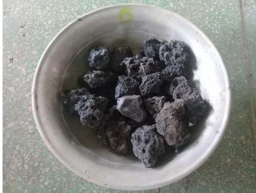
Anexo 27. Aplanamiento de escorias negras 1 1/2" - 1"
