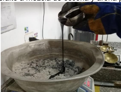
Anexo 52. Adición de asfalto a mezcla de escoria y arena para briquetas
