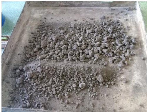
Anexo 40. Material resultante del ensayo de desgaste en máquina de los ángeles a ENHAE con 500 revoluciones
