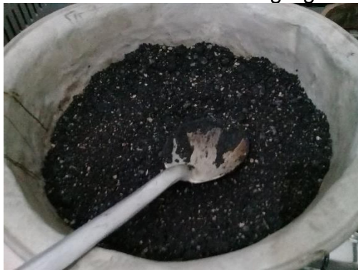
Anexo 55. Proceso de unificación de asfalto con agregados-Parte 3
