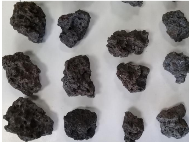
Figura 7. Evidencia de porosidad en ENHAE
