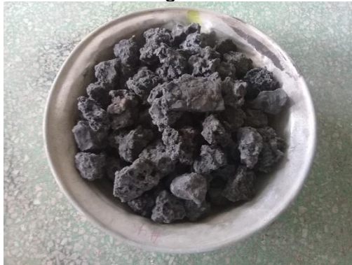
Anexo 28. Aplanamiento de escorias negras 1" - 3/4"
