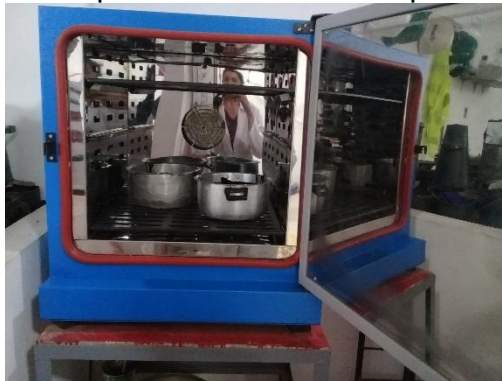
Anexo 48. Asfalto en el horno para mantener su temperatura
