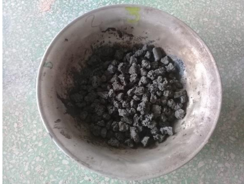
Anexo 30. Aplanamiento de escorias negras 1/2" - 3/8"
