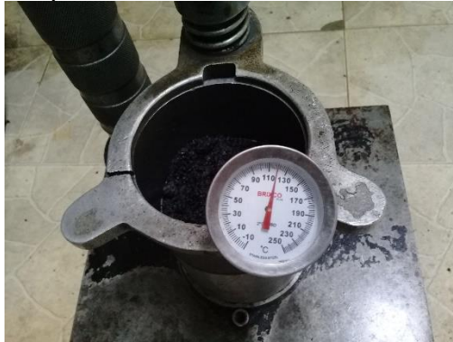
Anexo 57. Medición de temperatura de la mezcla en el molde (mordaza)
