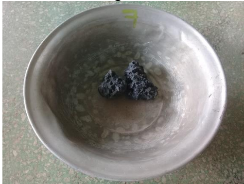
Anexo 32. Aplanamiento de escorias negras 2" - 1 1/2"
