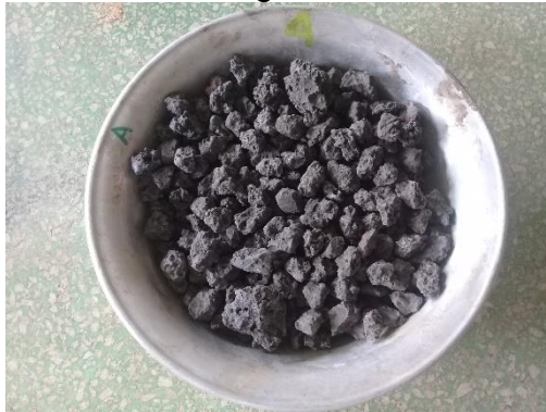
Anexo 29. Aplanamiento de escorias negras 3/4" - 1/2"
