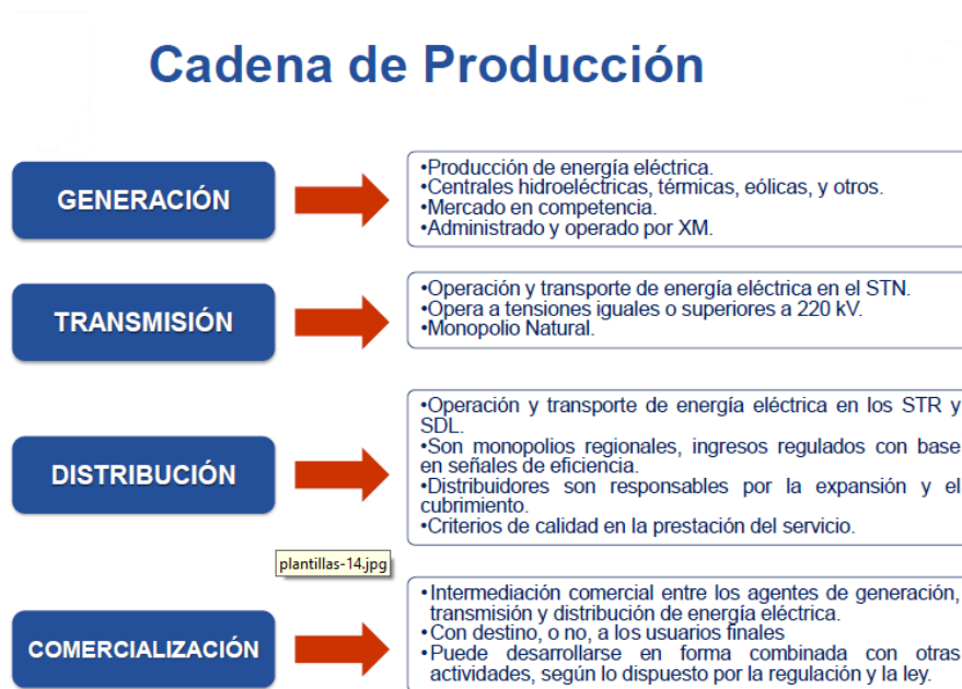
Figura 10. Cadena de producción de la energía eléctrica, adaptado de (CODENSA, 2018, pág. 10)
