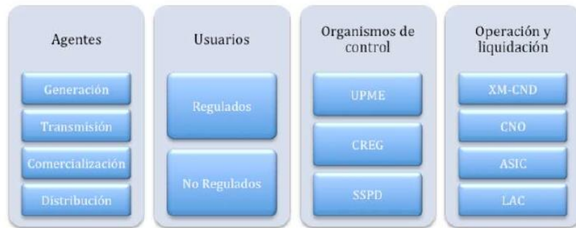
Figura 9. Diagrama esquemático del mercado eléctrico colombiano (UPME, 2016, pág. 46).
