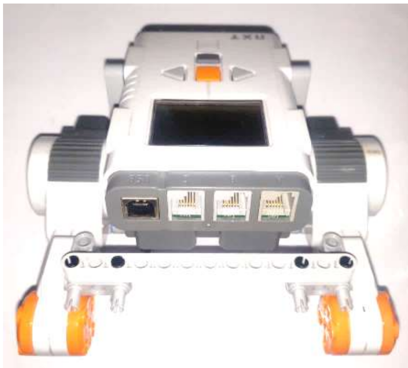
Figura 31. Montaje de barra transversal en Robot.
