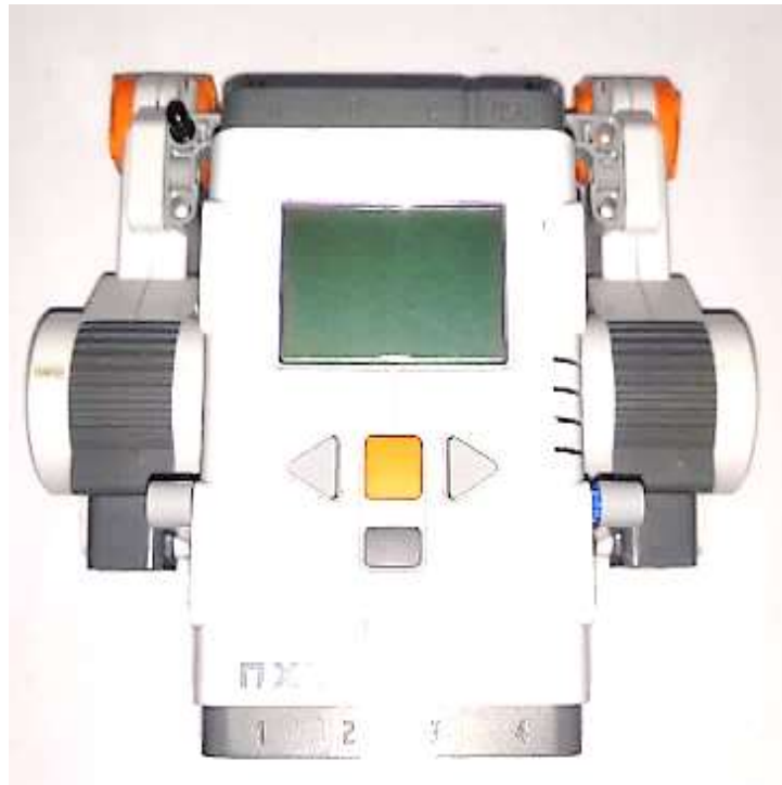
Figura 28. Montaje de Motor con Ladrillo NXT.
