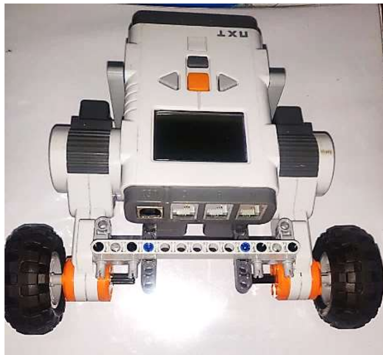
Figura 33. Montaje de Ruedas en Robot Lego.
