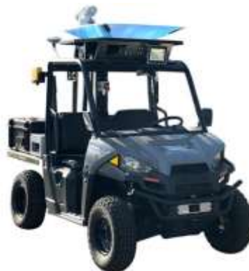
Figura 23. Configuración robot móvil tipo Ackerman.
