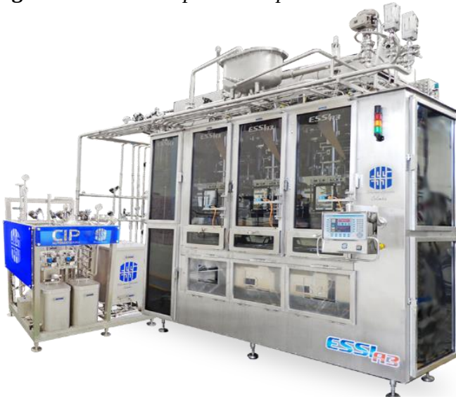
Figura 3 Cabina Aséptica Completamente Terminada.
