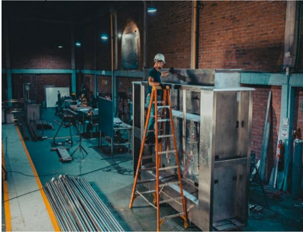
Figura 2 Cabina Aséptica en Proceso de Fabricación
