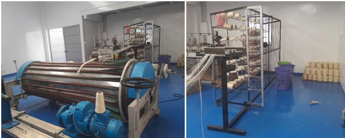
Figura 22. Urdidor y fileta
