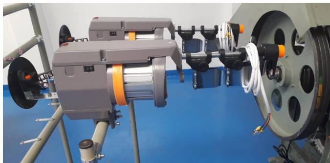
Figura 11. Acumulador de hilo (sensor) SDW 3-4 A
