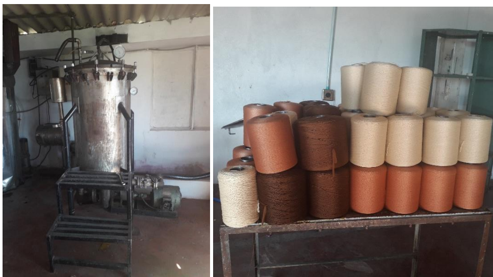
Figura 20. Olla de tintorería a vapor y conos teñidos
