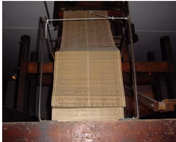
Figura 3. Telares Jacquard con tarjetas perforadas
