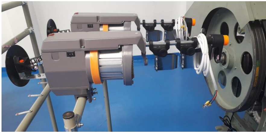
Figura 27. Acumulador de hilo (sensor) SDW 3-4 A
