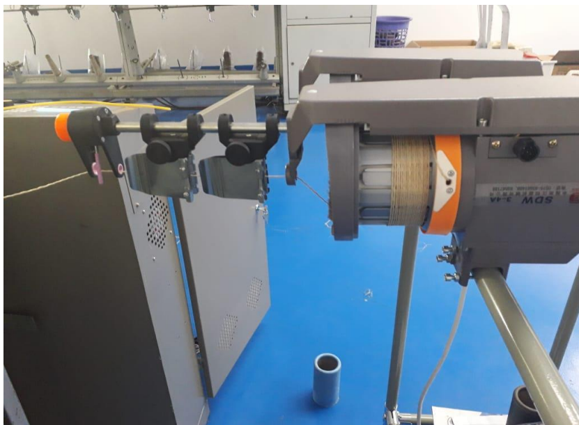
Figura 28. Acumulador de hilo (sensor) SDW 3-4 A, con hilo en el tambor para ser enviado al telar
