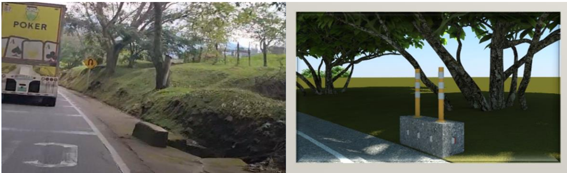
Figura 39 Señalización de obstáculo lateral
