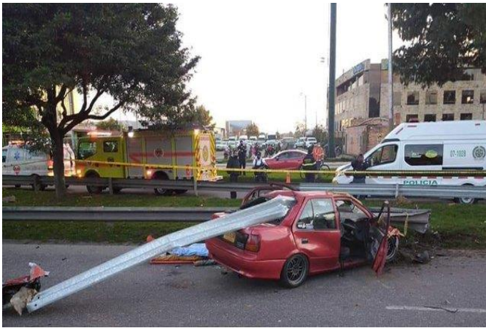
Figura 1 Accidente de vehículo que impacta con bionda – Bogotá D.C. (10 de abril 2021)
