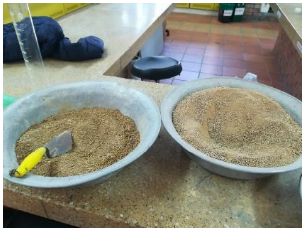
Figura 33: Preparación y adición de agua con aceite sulfonado a material granular. Nota: Elaboración propia
