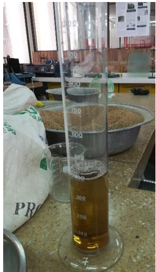
Figura 33: Preparación y adición de agua con aceite sulfonado a material granular. Nota: Elaboración propia
