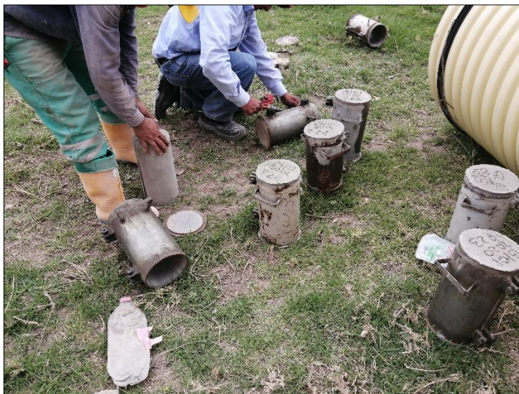
Imagen 37 Fundición de cilindro en concreto
