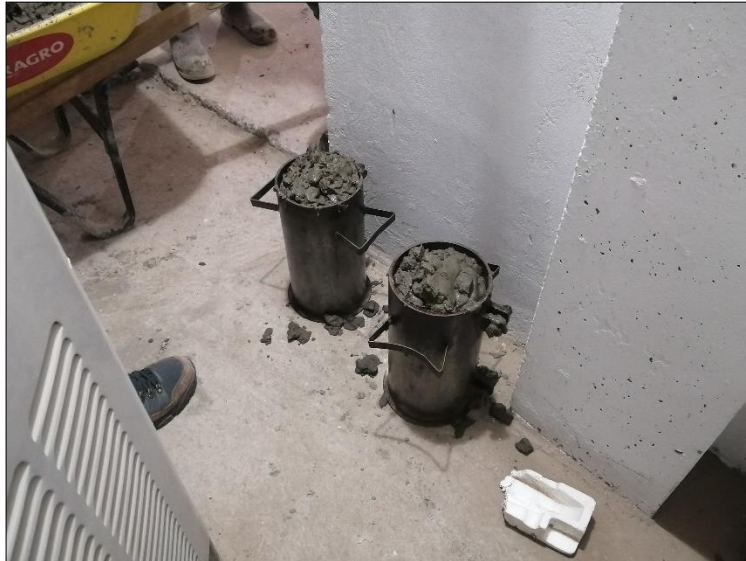
Imagen 36. Fundición de cilindro en concreto
