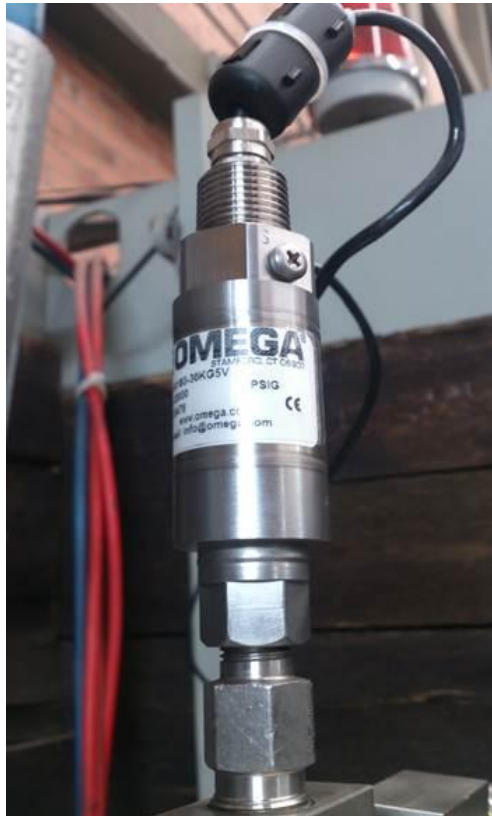
Figura 34: Transductor nuevo, empleado en la Bahía de Presión, referencia PX41S0-30KG5V
