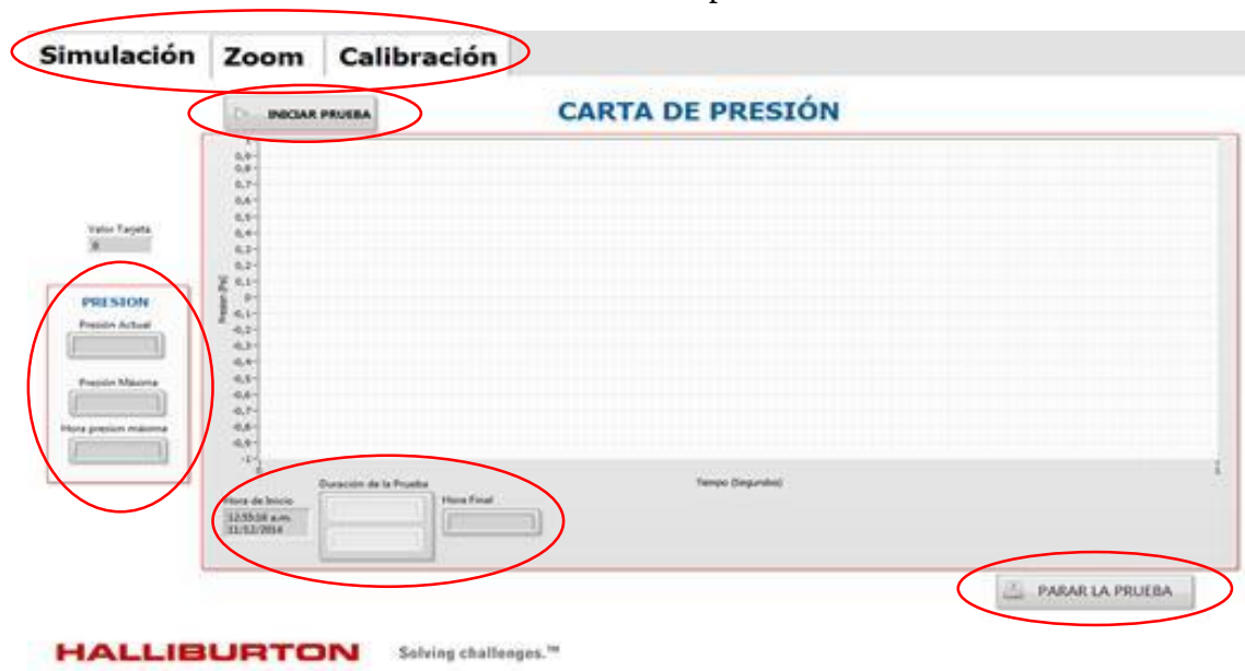
Figura 37: Botones, pestañas e indicadores de inicio, finalización de la prueba, indicadores de presión actual y máxima, hora y fecha de inicio de la prueba, duración y finalización de la prueba.
