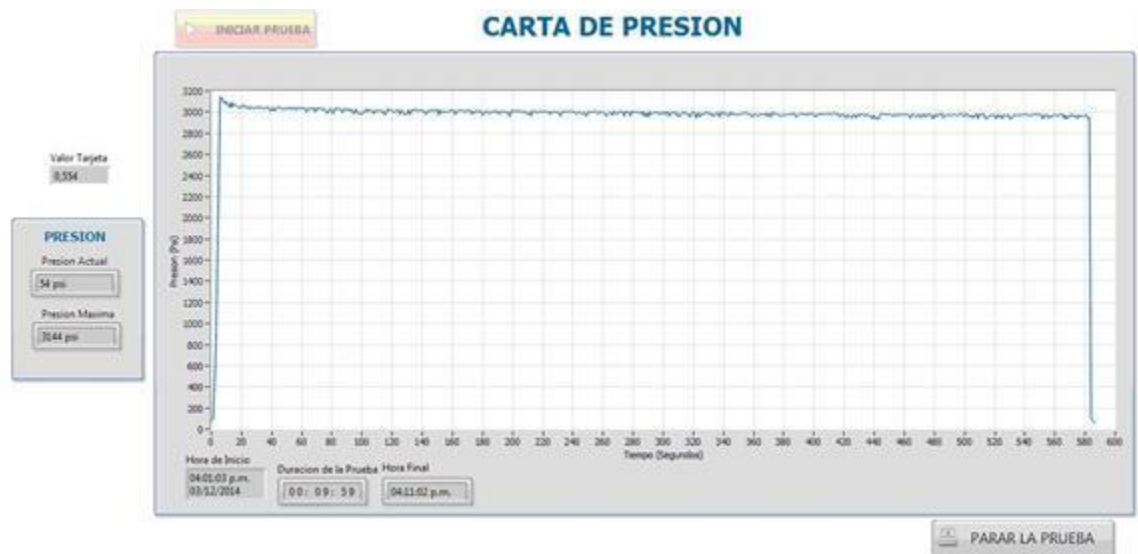
Figura 43: Prueba para certificación de Manifolds empleados para muestreo en Superficie
