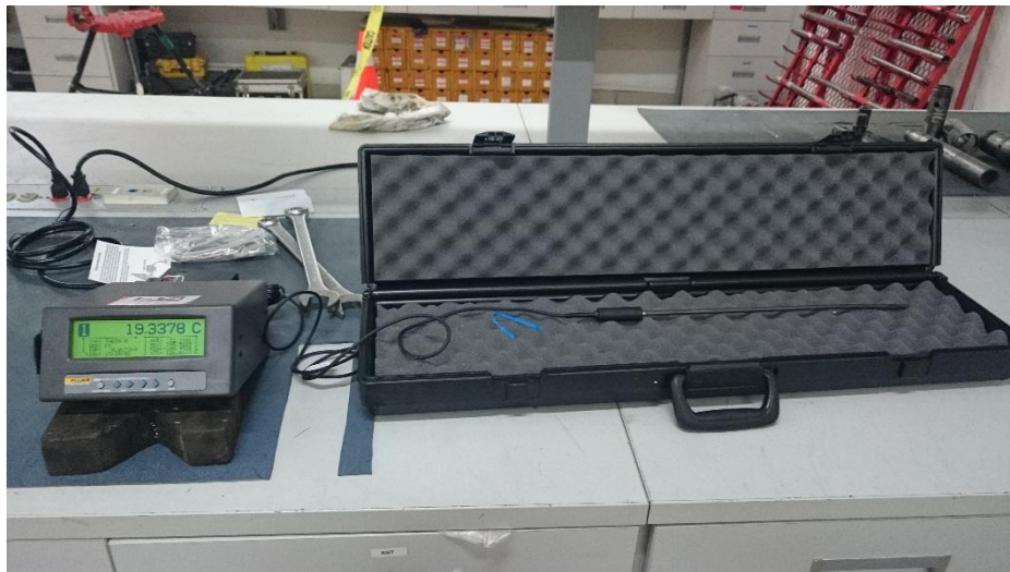
Figura 19: Toma de temperatura con el sistema Fluke.
