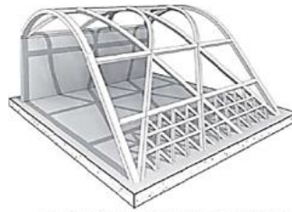
Fig. A1 Bóveda exterior, Estructura y Módulos
