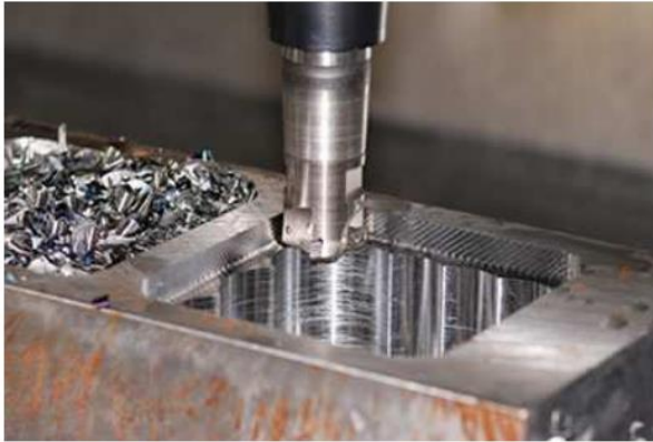
Figura 12. Desbaste por penetración.
