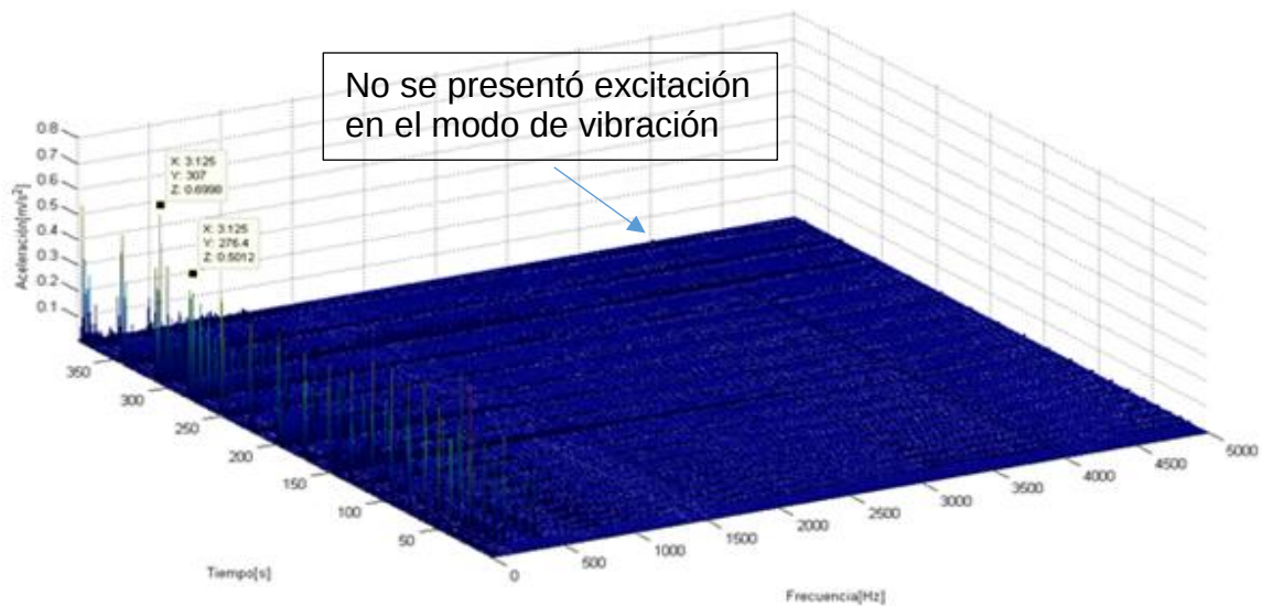
Figura 73. Aceleración vs Tiempo vs Frecuencia, ER32 3200RPM cortando
