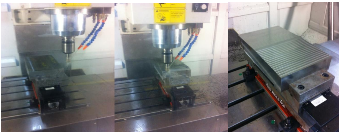
Figura 22. Proceso de fabricación de escalones
