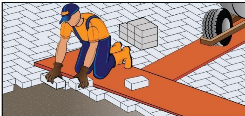
Figura 12. Colocación de los tramos del pavimento
