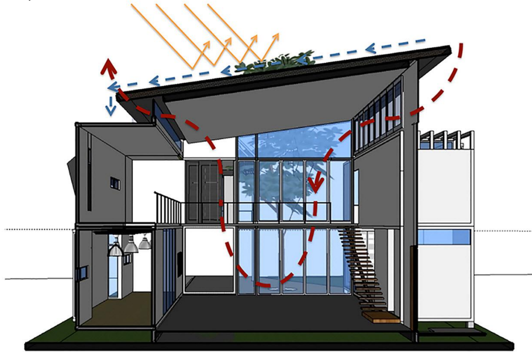
Figura 22. Esquema ventilación cruzada vivienda
