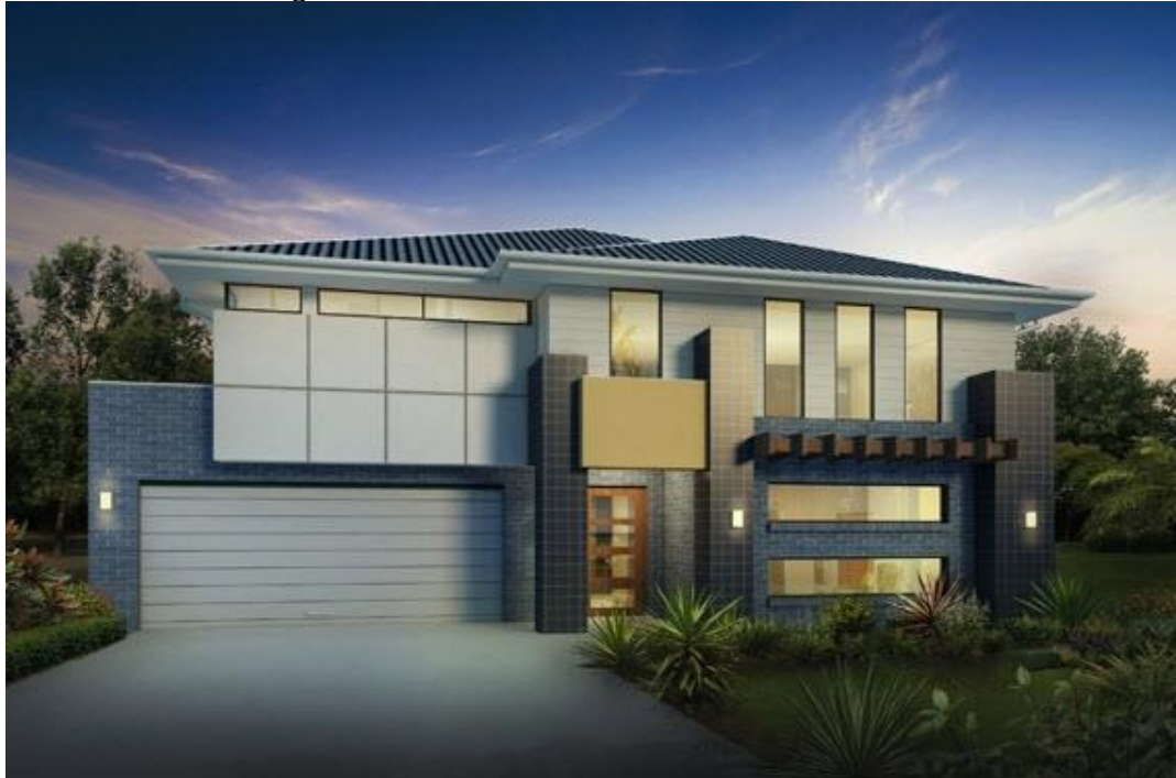
Figura 21. Vivienda cubierta 4 aguas
