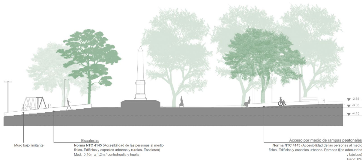
Figura 56. Detalle de normativo para las circulaciones
