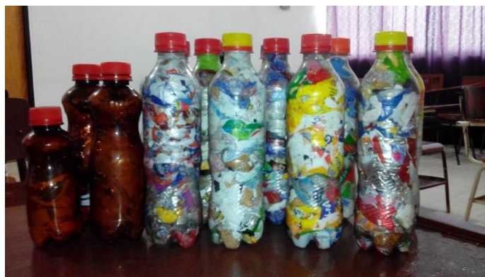
Figura 13. Poporos ecológicos (ladrillo ecológico). Fuente: salón 21 del Colegio Integrado del Carare, segundo piso, sede A (básica secundaria y media).
