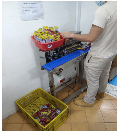
Figura 6. Operación de sellado
