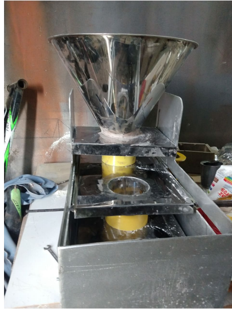
Figura 22. Tolva y estructura principal
