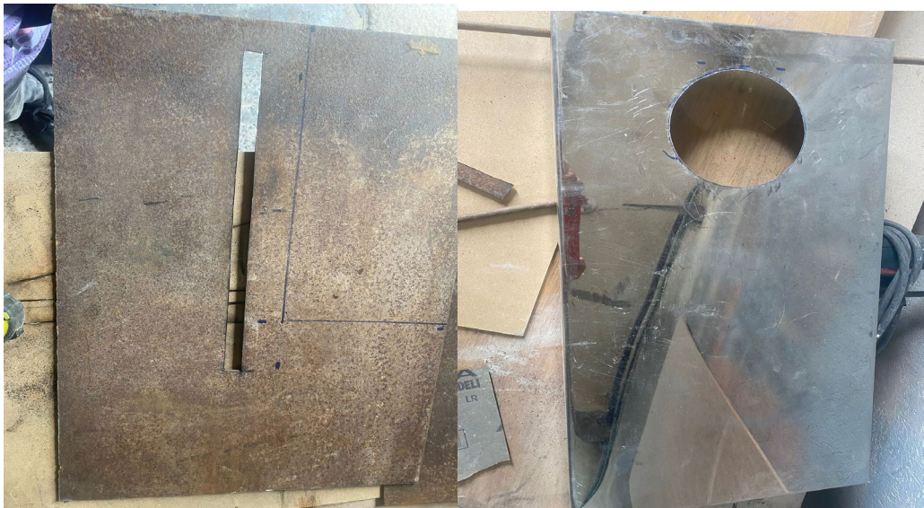
Figura 20. Cortes en láminas acero galvanizado de (60cm x 180cm)
