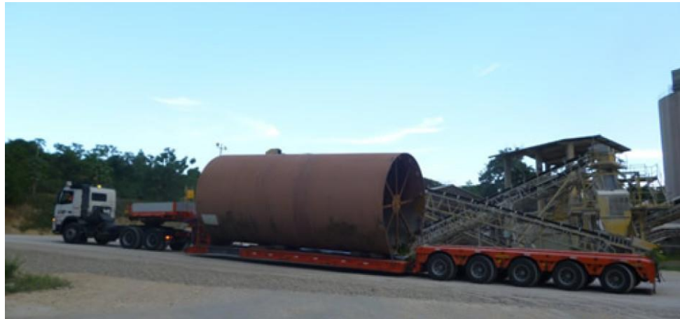
Figura 1. Vehículo de transporte de carga extra dimensionada en Colombia Fuente: http://boomlts.com/
