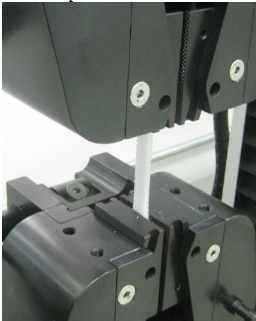
Figura 26. Ensayo de tensión. a) Montaje de probeta para ensayo de tensión. b) Muestra de falla en probeta de PMMA.
