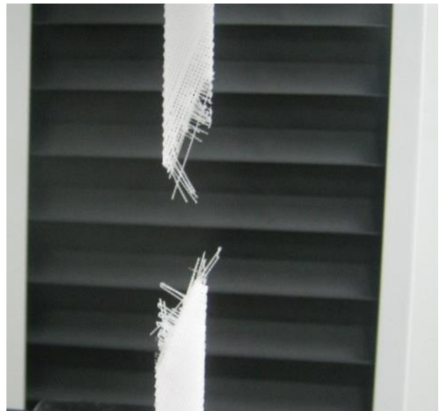
Figura 26. Ensayo de tensión. a) Montaje de probeta para ensayo de tensión. b) Muestra de falla en probeta de PMMA.
