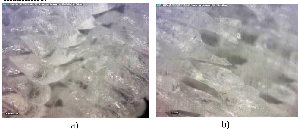
Figura 52. Efectos de la compresión en los filamentos 200x. a) Efectos de la compresión b) Efectos de tensión como reacción a la compresión en los filamentos.
